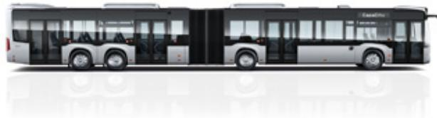
Comprimento [mm]: 19 725      Altura [mm]: 3 095
