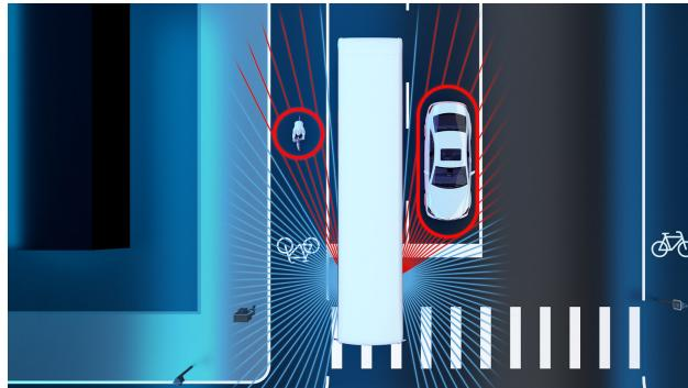
O Sideguard Assist 2 é um sistema de assistência de segurança que apoia permanentemente o condutor em ambos os lados em situações críticas de viragem com visibilidade potencialmente restrita. Ao virar ou mudar de faixa, o sistema deve ajudar a reconhecer obstáculos em movimento dentro dos limites do sistema e alertar o condutor para evitar situações críticas ou reduzir as consequências de um acidente.
