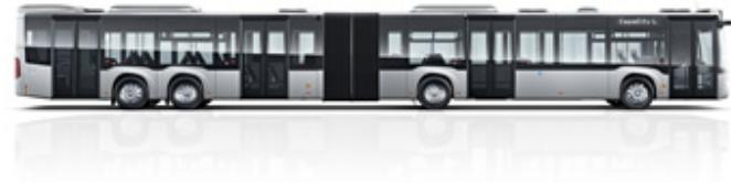
Comprimento [mm]: 20 995      Altura [mm]: 3 095
