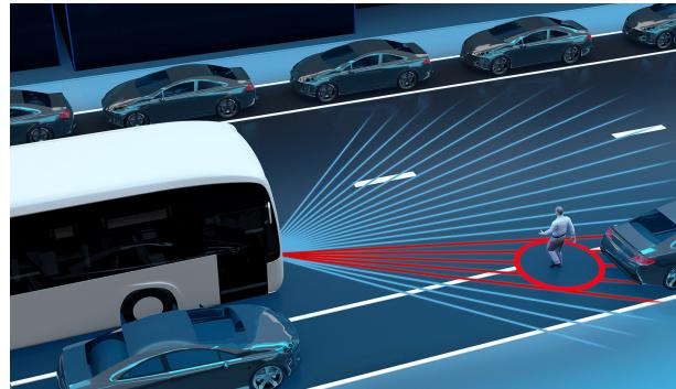
Com o Preventive Brake Assist 2, a Daimler Buses oferece a segunda geração de assistência ativa à travagem para autocarros urbanos. O sistema alerta sobre colisões com pedestres e ciclistas em movimento, bem como com objetos parados e em movimento. Se existir um risco agudo de colisão, o condutor é alertado por um aviso visual e acústico e a travagem parcial é iniciada automaticamente.
