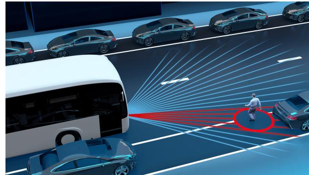
Avec le Preventive Brake Assist 2, Daimler Buses propose pour les bus urbains la deuxième génération du freinage d'urgence assisté actif. Le système avertit de collisions avec des piétons et des cyclistes en mouvement ainsi qu'avec des objets immobiles et en mouvement. En cas de risque imminent de collision, le conducteur est averti par un signal visuel et sonore et un freinage partiel est automatiquement déclenché.
